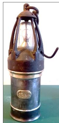
Lampe électrique ogivale de Douai en usage dans les mines après 1918
